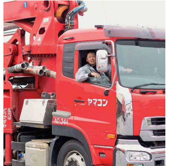
赤い色がひと際目を引く、コンクリートポンプ車に乗り込む荒木さん。折りたたみ式の4段ブームの長さは36m。作業の様子は圧巻だ。広い現場での作業効率化を図るため、全国でも数台しかない47mの作業車の導入を今後予定しているそう。
