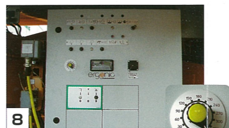
8 操作盤 リリーフ圧調整ダイヤル(打設現場状況に応じて最高圧を調整出来ます)
